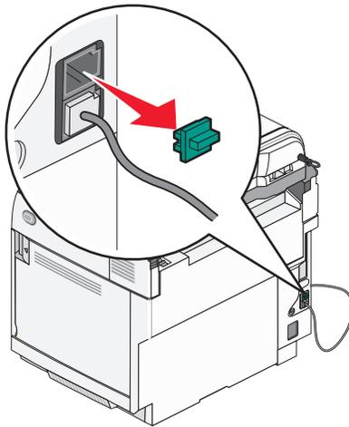
**4** 将另一条电话线连接到电话上，然后将它插入打印机的 **EXT** 端口
