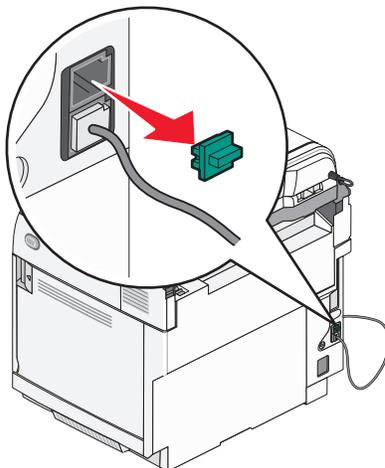
4 将第二条电话线从电话连接到计算机调制解调器上。
