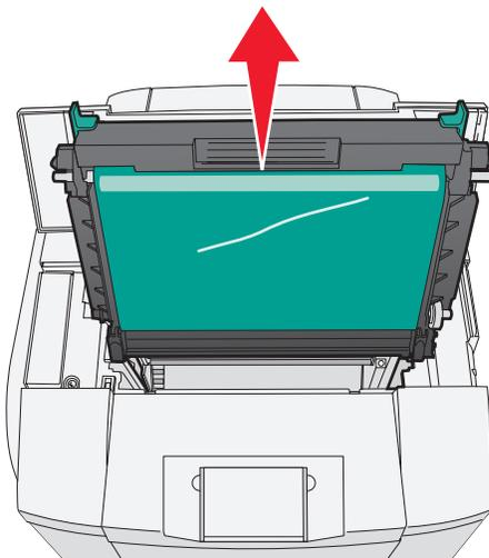
7 拉凸柱以抬起防尘玻璃盖板。
