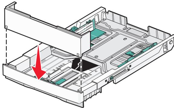
7 将纸堆按推荐的打印面朝上加载，并关闭防尘盖板。
