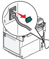
**注意：**当去掉保护塞后，您通过适配器连接在打印机上的任何国家 / 地区的设备（如图所示）都将不能正常工作。
