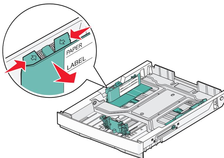
**注意：** 请注意进纸匣底部左边的尺寸指示器。使用这些指示器有助于放置导片。请注意进纸匣侧面上的加载线标签，它指示纸张的最大堆放高度。
