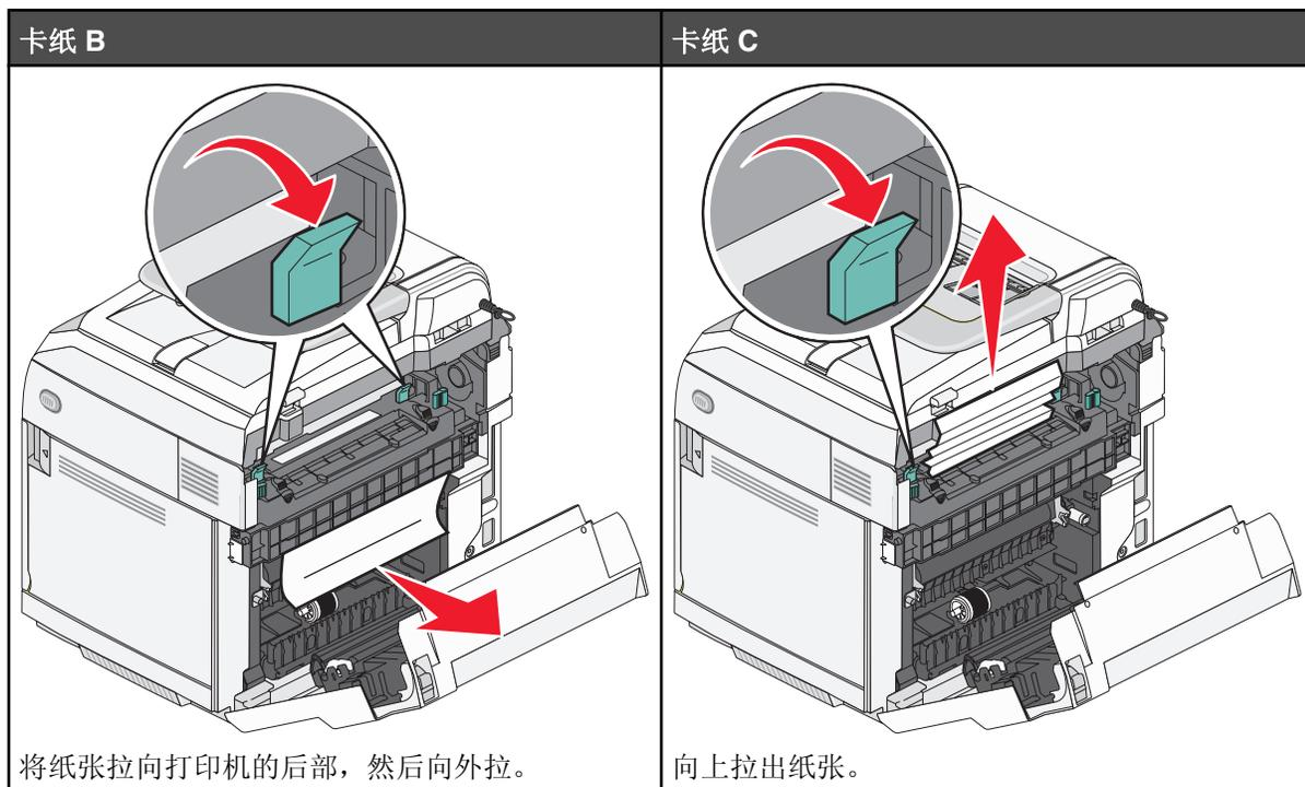
**注意：**轻轻地拉出纸张以避免撕破。只要可能，将纸张朝打印机底部方向拉以避免污染熔印部件。
