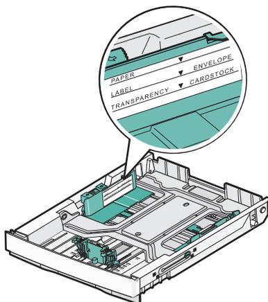
3 如图所示，将宽度导片凸柱一起压住，将宽度导片滑动到与加载的纸张尺寸相符的正确位置上。
