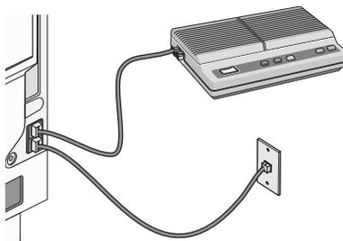
**注意：** 当去掉保护塞后，您通过适配器连接在打印机上的任何国家 / 地区的设备（如图所示）都将不能正常工作。
