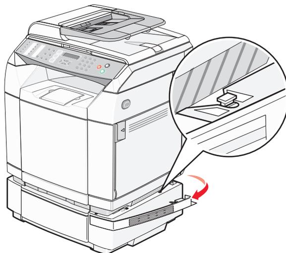
**4** 通过从打印机后部开始，从后到前轻轻地将四个开槽拉离其相应的凸片来移除左侧盖板。
