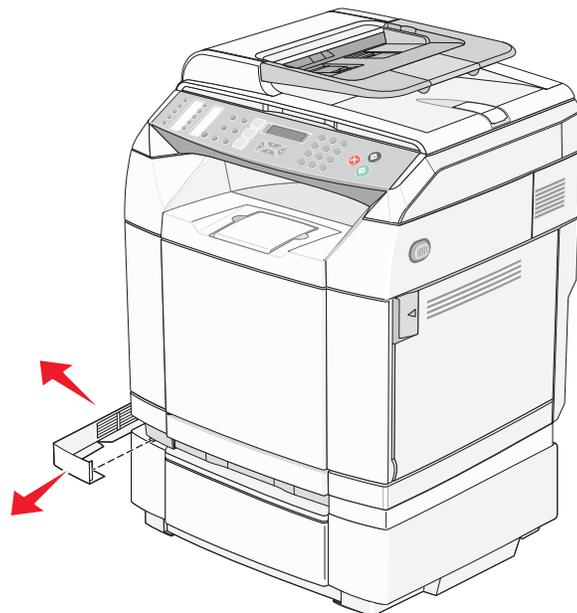
5 松开右边的翼形螺钉，并移除右边的支架。
