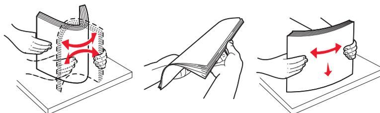
5 装入纸堆，让推荐的打印面朝上。如图所示，将纸堆朝着进纸匣的后部放入。
