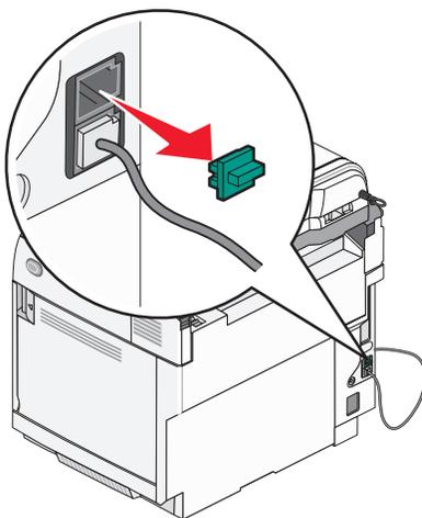
**4** 将第二条电话线从电话连接到应答机上。
