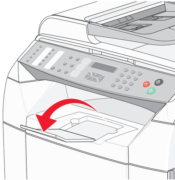
纸张支架倾斜以便纸张整齐地堆放在标准接纸架中。
