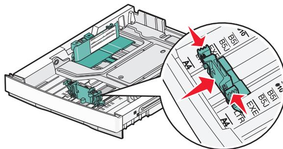
**注意：**请注意进纸匣底部导片两边的尺寸指示器。使用这些指示器有助于放置导片。
