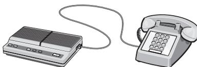
5 将第三条电话线从应答机连接到打印机的 EXT 端口
