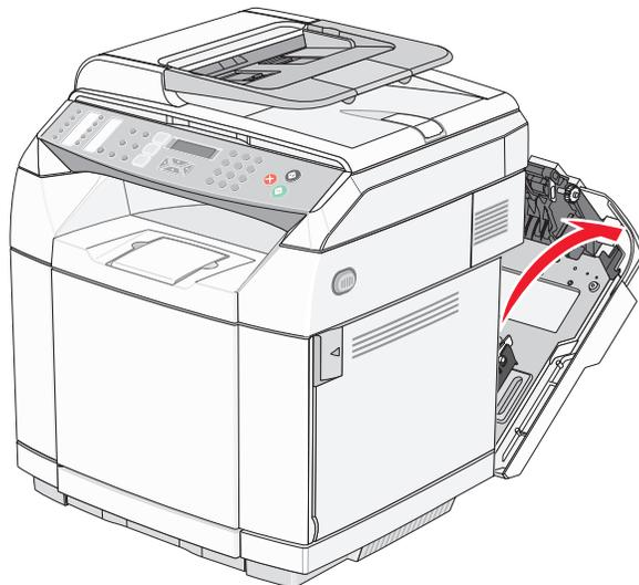
3 拉熔印部件压力释放杆来释放纸张上的压力。
