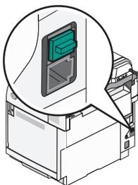
**注意：**请不要去掉保护塞。如果您去掉了保护塞，您家中其他的电信设备（例如电话机或电话答录机）可能无法正常工作。
