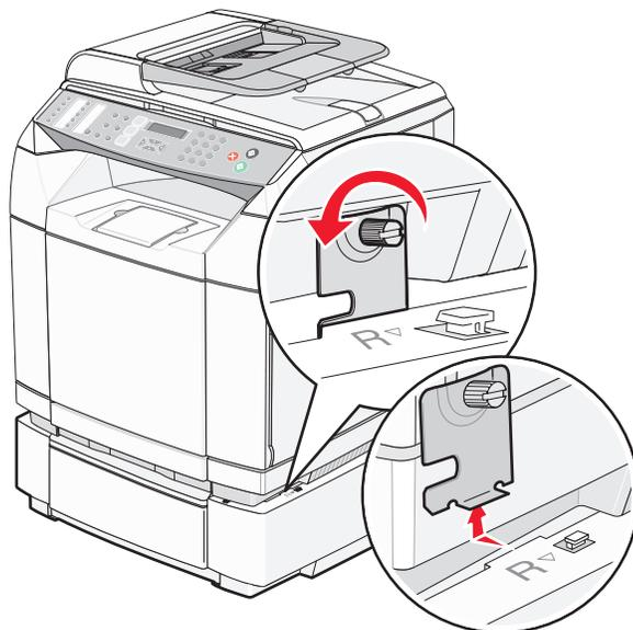
6 松开左边的翼形螺钉，并移除左边的支架。
